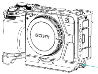
将线夹①安装在笼子侧面的M3螺纹孔上, 拧紧螺丝②完成装配。
