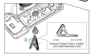
图 需先无损拆卸原装 摄影机上的三角挂环, 再将M2.5螺丝③通过 挂环接口锁紧在笼子 上完成装配。
