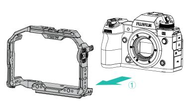
1.将摄影机装入①X-H2S全笼,再取出笼子底部的②一字扳手,将机身定位螺丝 **③**和一字螺丝 **⑤**锁进笼子底部的安装孔完成装配。
